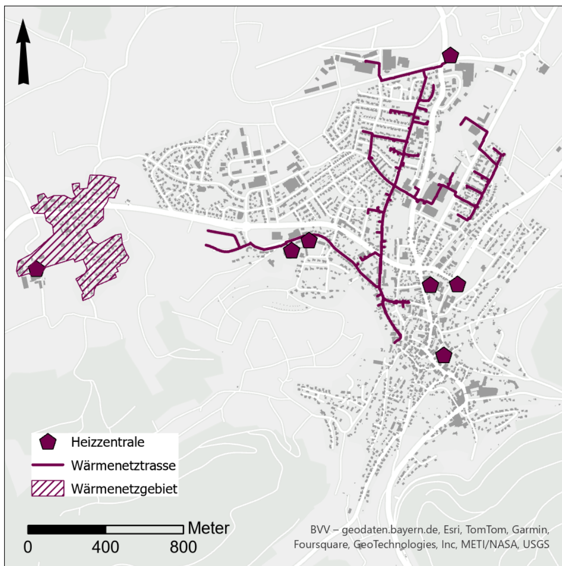
Abbildung 10: Kartografische Darstellung der bestehenden Wärmenetze und Heizzentralen
